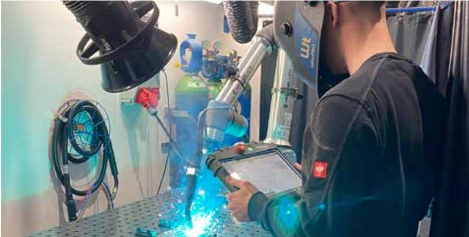
Für die Firma Caleg aus Calau – Anbieter für Gehäuse-technik, Schranksysteme und Baugruppen-träger – wird im Projekt PAL ein cobotbasiertes Schweißsystem zur Unterstützung des Menschen im Prozess entwickelt. Diesem Vorhaben widmet sich einer der zwölf Praxisvorträge des Transfertags.
