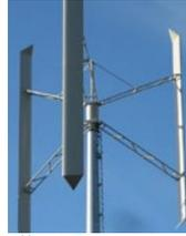
Abb. 1: H-Rotor einer VAWT.
