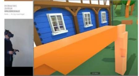
Bauteile, Bauelemente, Baugruppen lassen sich mit den Controllern der VR-Brille zu unterschiedlichen, zimmermannsmäßig korrekten Konstruktionen zusammensetzen und wieder auseinandernehmen.
