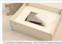
3-Schicht-Kalorimeter mit PCM-Probenbeutel
