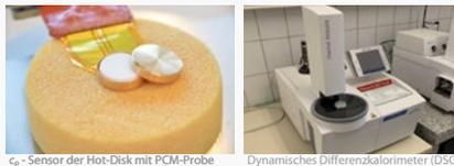
c<sub>p</sub> - Sensor der Hot-Disk mit PCM-Probe
