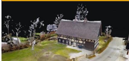
Die mit Punktwolken oder photogrammetrisch aufgenommenen 360°-Hausrundgänge ermöglichen eine vollständige Besichtigung der Umgebendehäuser von innen und von außen.
