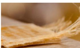
Die Trocknung schließt sich direkt an den mikrobiellen Aufschluss an, der dem Waschen der Pflanzen und dem mechanischen Aufschluss folgt. Die **Qualität** der getrockneten Fasern **entscheidet** über die nachfolgend möglichen **Verwertungswege**. Nachdem die getrockneten Fasern sortiert sind, liegen sie als definierte Pflanzenfasern vor, die entweder als Presskörper, im Spritzgussverfahren oder der SMC-Technik (Sheet Molding Compound) ihren Einsatz finden.
