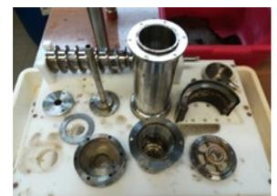
Dekantierzentrifuge nach Demontage am Versuchsende – Keine erhöhte Verschmutzung
